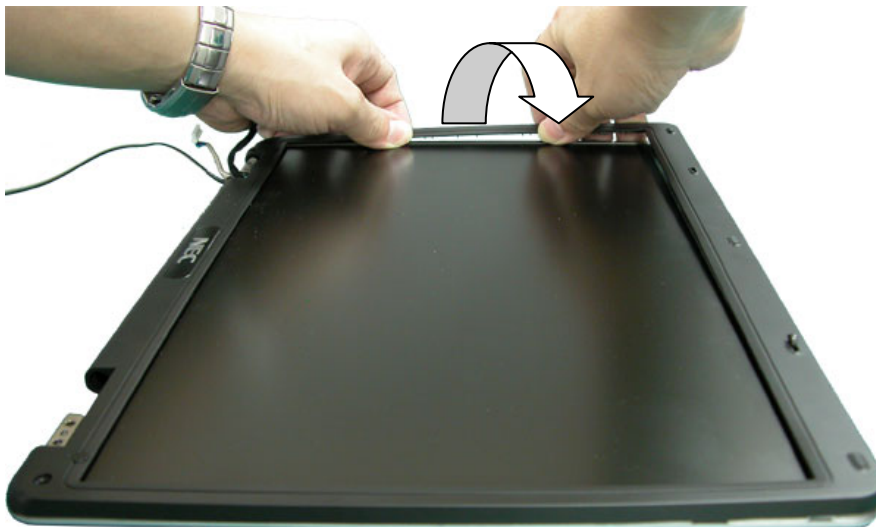
Fig. 26 Removing the LCD Bezel
